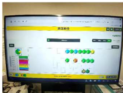
「全体監視」 15台の設備をネットワーク接続し リアルタイム状況を一括表示
