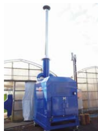
自社開発したバイオマスボイラー
