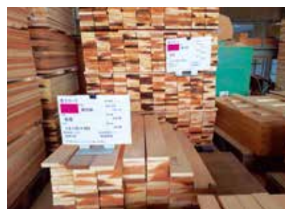
《工程前ストア（置き場）と着工カード》
