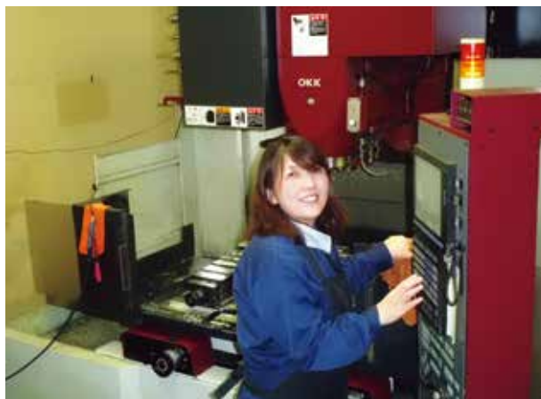
マシニングセンターによる加工の様子
