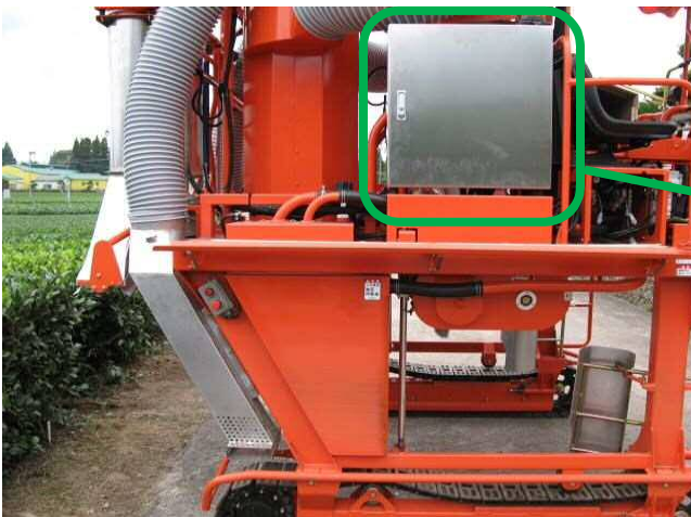
制御システムの外観
