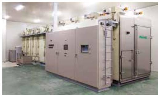
モジュール型蒸熱処理装置
