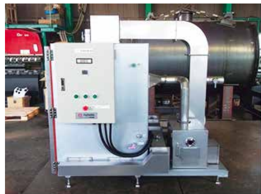
「試作機の燻煙装置（右下）」
