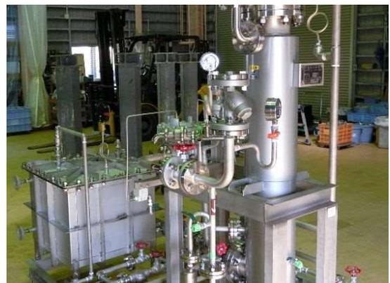
SIP処理装置試作品の外観
