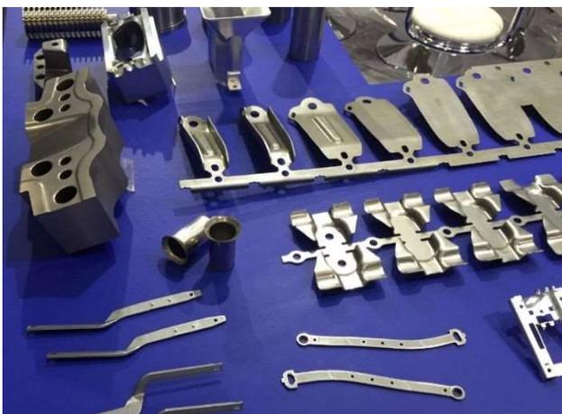
自動車部品用試作金型の部品
