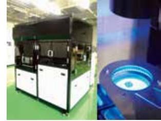
《アロン電機(株)： 工具チップ外観検査装置》
