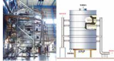
《株式会社ヨシカワ：石炭プレ乾燥装置とカットモデル図》
