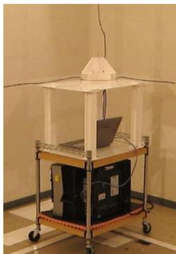
(写真1) 静電気発生箇所検出装置
