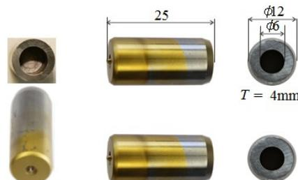
(写真4) 長寿命化した鍛造工具(従来工具より3.7倍の長寿命化)
