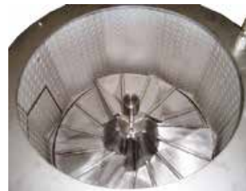
衛生的に改良した 豚足脱毛機の内部
