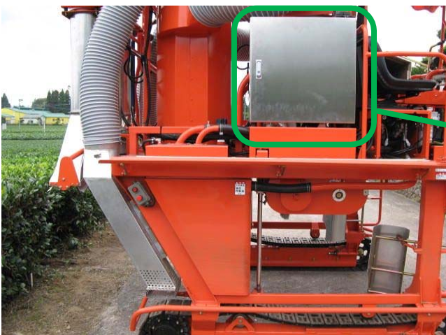
制御システムの外観
