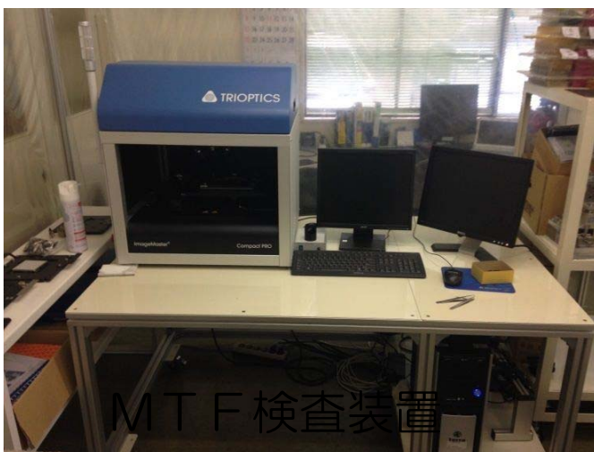
組立検証用 MTF 検査装置
